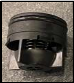
Eingelegter Schmutzsieb im Rücklauf
